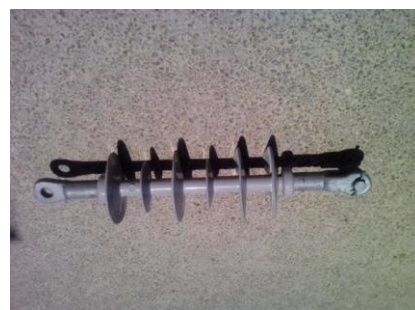
شکل (۱۵) مقره پلیمری کششی و عبوری مناسب.
